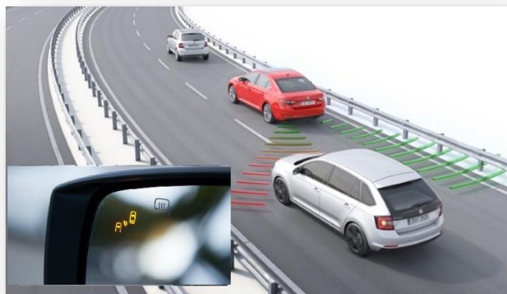
شکل 10: نحوه عملکرد سیستم پایش نقاط کور خودرو
