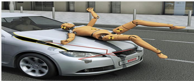
شکل 13: سیستم حفاظت از عابر پیاده به هنگام تصادف
